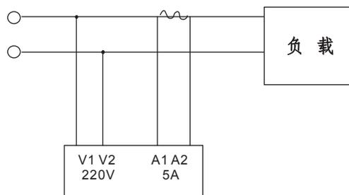
★三相平衡负载测量时，接线方法如下：
